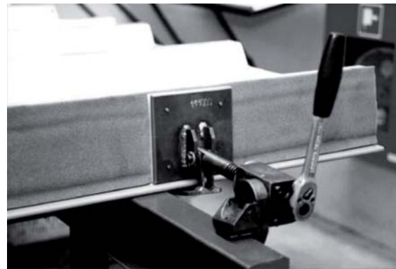
Рис. 3. Монтажний інструмент Ruukki 1410
