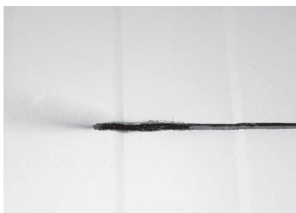
Фото 2. Запрещается выполнять резку с помощью абразивных инструментов (например «болгарок») из-за возможного повреждения антикоррозионного покрытия.
