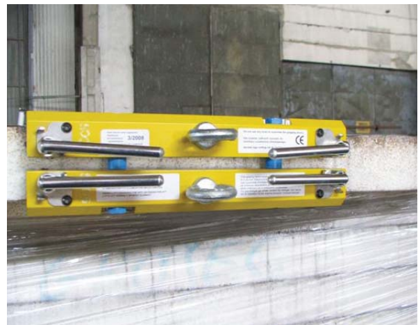
Фото № 9. Использование подъемного монтажного инструмента для сэндвич-панелей при размещении в вертикальном положении, длина \leq 6 м.
