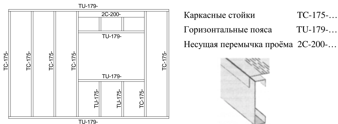
Рис. 3.2 Типичные элементы термопрофильного каркаса
